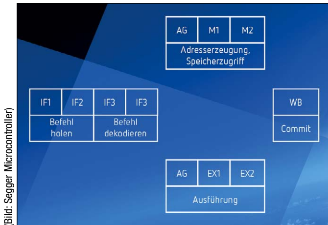
Bild 3. Die 8-stufige Dual-Issue-Pipeline des SiFive S7-Cores.
